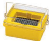
Kühlbox aus Polycarbonat (PC) zum Schutz von Enzymen und Lösungen durch Einkühlen zwischen -20 °C und -15 °C für zwei Stunden. Der Boden ist mit nicht-toxischem Gel gefüllt. Gelb. Der Aluminiumblock weist 96 Vertiefungen (8 x 12) für 0,2 ml Röhrchen, Streifen oder Platten auf. Vor der Verwendung 24 Stunden bei -20 °C / -25 °C einfrieren.
