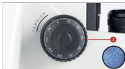
2 – Fokussieren Sie das Bild über die makro- und/oder mikrometrischen Fokusschrauben, bis das Bild scharf ist.
