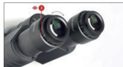
3 – Sehen Sie mit dem linken Auge durch das linke Okular. Drehen Sie das Rädchen für die Dioptrieneinstellung bis das Bild scharf sichtbar ist.
