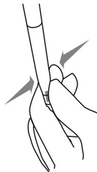
Das Pellet in der Flüssigkeit zerkleinern, indem Sie den unteren Teil der Einheit zusammendrücken, bis sich das Pellet aufgelöst hat.
